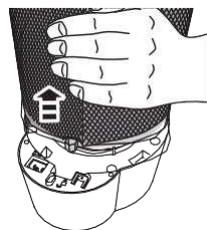
Desbloquear el cartucho filtrante en la pieza de cierre (A)
