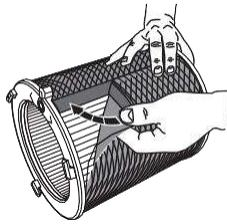
Volver a colocar la cubierta de tejido (solo IDEAL AP40 PRO) en el cartucho filtrante y cerrarla en la parte posterior (pieza de cierre **A**).
