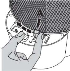
Introducir el cartucho filtrante con las tres lengüetas de encastre en las tres ranuras previstas para tal fin y bloquearlo en la pieza de cierre (**A**).
