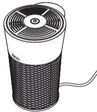
Enchufar primero el cable de red en el aparato y, a continuación, en la toma de corriente. El aparato solo funcionará si el cartucho filtrante está correctamente montado.
