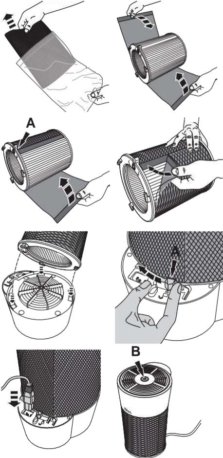
Extraer la cubierta de tejido (solo IDEAL AP40 PRO) de la lámina de protección, colocarla alrededor del cartucho filtrante y cerrarla en la parte posterior (pieza de cierre **A**).
