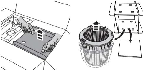
Levantar el cartucho filtrante de la caja, desmontarlo y quitar la lámina de protección.
